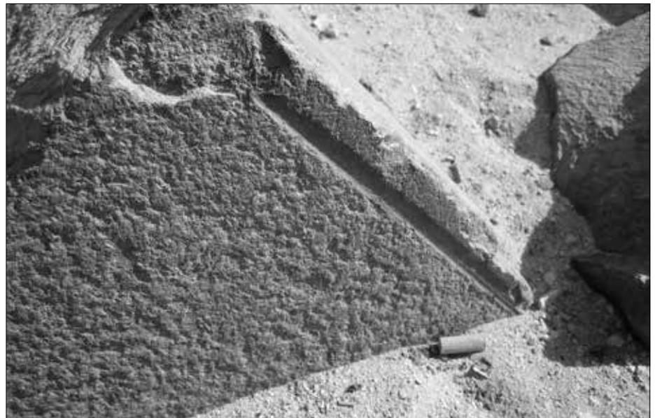
*Fehlschnitt. Hier ist die Fräse aus der Richtung gerutscht.*
